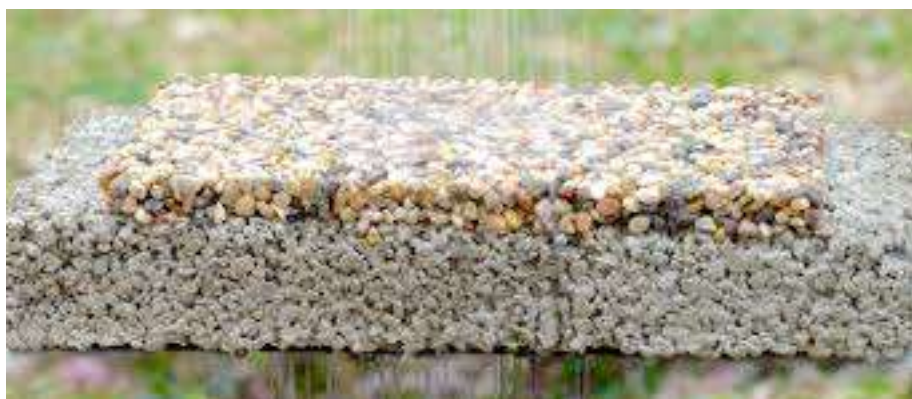
Dettaglio stratigrafia DRENATECH
